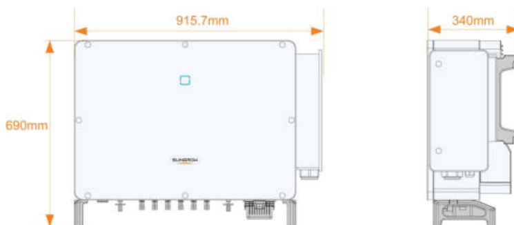
Rysunek 2-3 Wymiary falownika (w mm)
